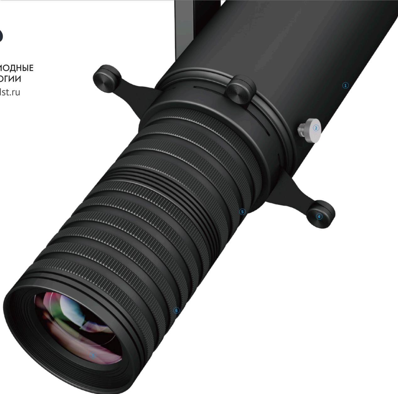
① Корпус светового прибора, который одновременно является и радиатором охлаждения, изготавливается из высококачественного алюминия марки 1070 методом литья под высоким давлением. Он обладает высокой теплопроводностью 226 Вт/кв.К, низкими перепадами температур и длительным сроком службы.
